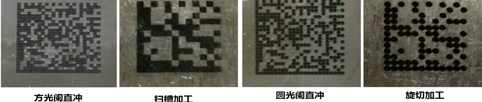
航空航天构件的飞秒激光高品质图案标印
