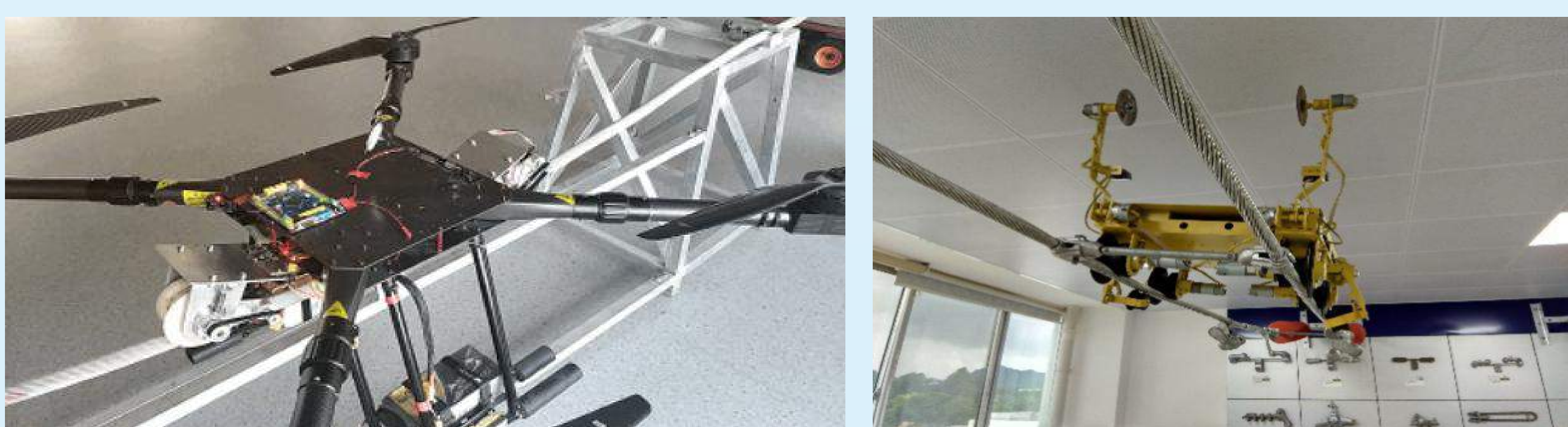
高压输电线巡检机器人
